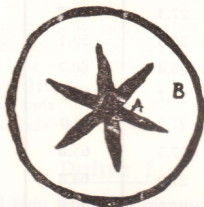
Gambar 4 : Potongan melintang kayu dimana ada pertjambangan.
